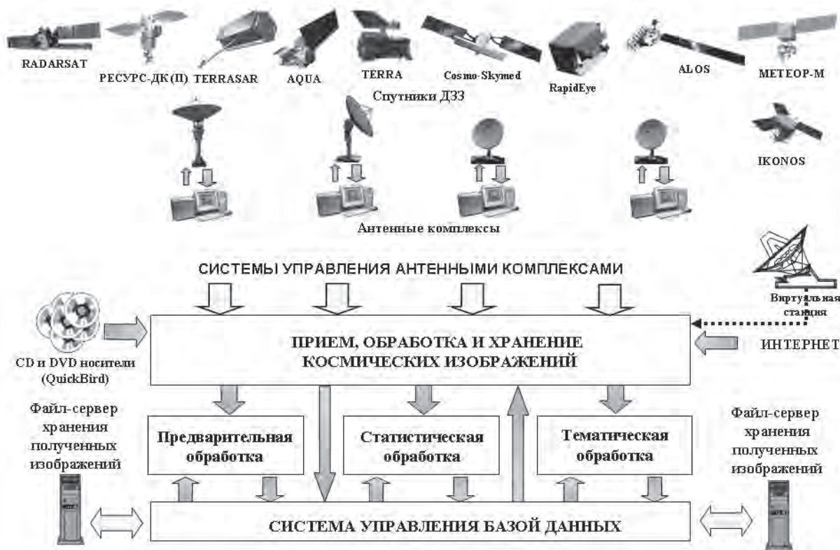
Рис. 1.1.2. Организация приема, обработки и хранения данных при космическом мониторинге
