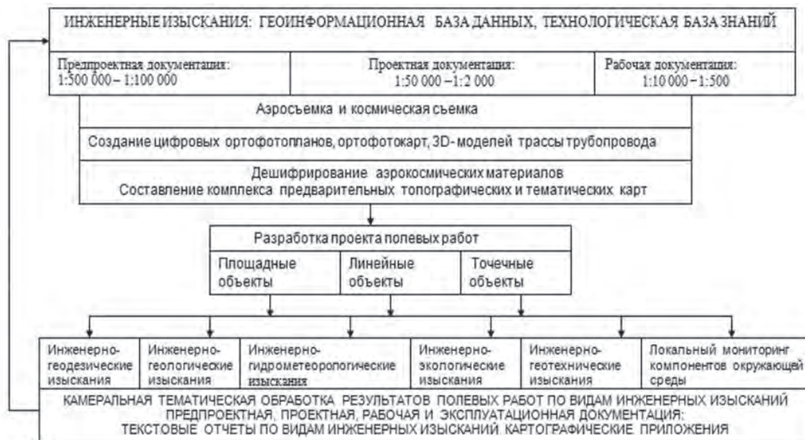
Рис. 7.7.1. Рекомендуемая технологическая схема инженерных изысканий
