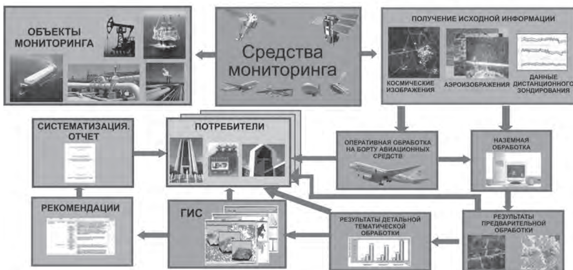
Рис. 1.1.1. Структурная схема проведения аэрокосмического мониторинга объектов нефтегазового комплекса и формирования информационных продуктов в его процессе
