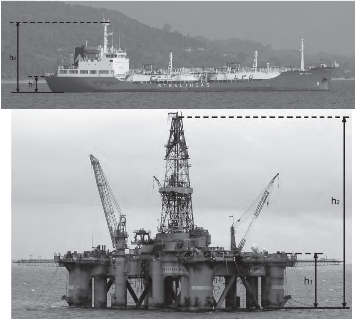
Рис. 7.2.1. К определению высоты расположения основных отражателей исследуемых объектов
