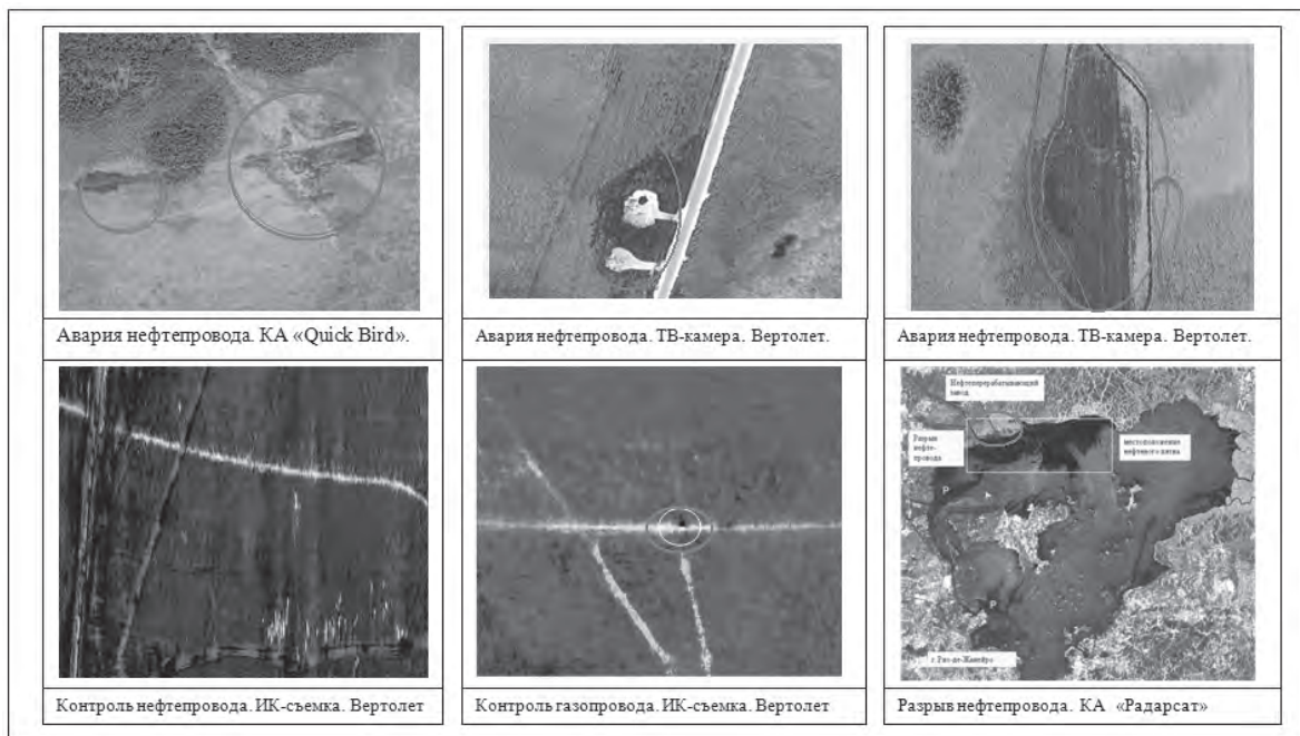
Рис. 7.7.9. Аэрокосмические изображения при контроле эксплуатации трубопровода. Локальный мониторинг на стадии эксплуатации
