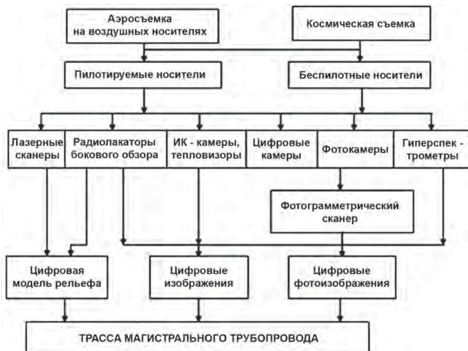
Рис. 7.7.4. Структурная схема получения аэрокосмических изображений
