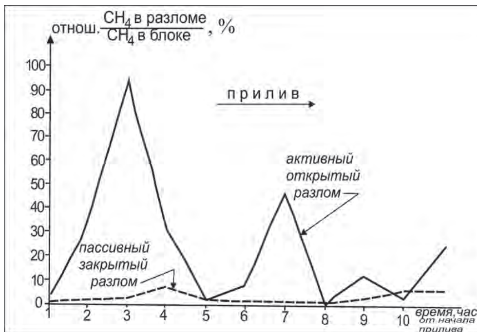
Рис. 3.7.4. Выделение гидрогеологически активных разломов по газогеохимическим признакам
