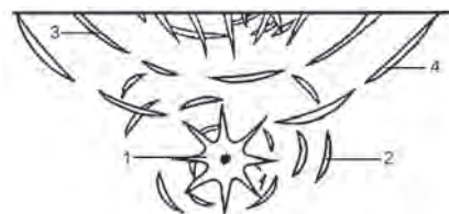
Рис. 2.6.4. Схема системы трещин в горных породах при взрыве заряда взрывчатых веществ вблизи поверхности (Попков, 2005): 1 – радиальные трещины, 2 – кольцевые трещины, 3 – трещины разлома, 4 – откольные трещины
