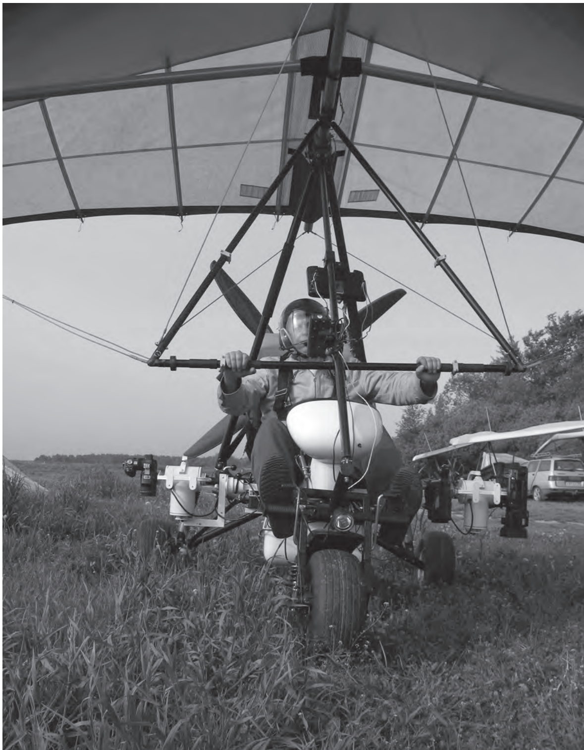
Рис. 7.8.1. Бортовой программно-аппаратурный комплекс локального аэромониторинга в базовой комплектации, размещенный на борту дельталета «Поиск-06 НТ»
